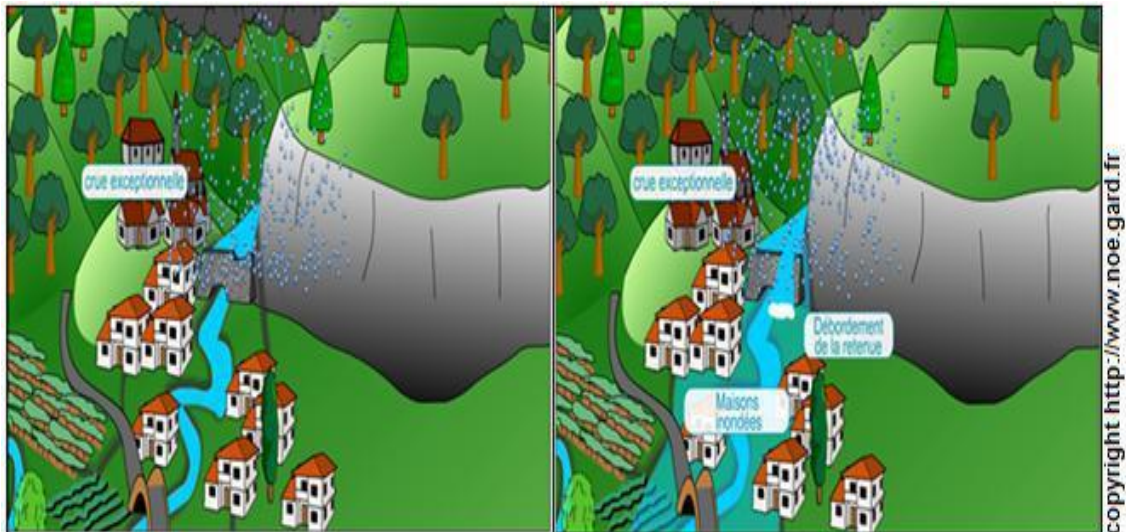
Figure 06 : Inondation par débordement au-dessus de la digue (Medi, 2014).
